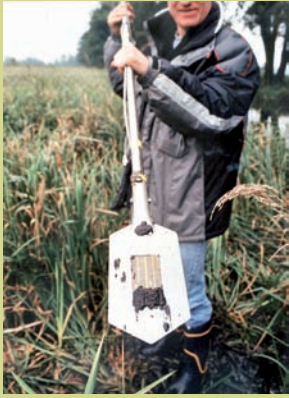
System mit optimiertem Messverfahren im Feldeinsatz, hier der Bestimmung der Temperaturleitfähigkeit des Bodens in einem Projekt zum Klimaschutz
