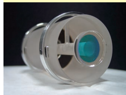
Ultrastabiler optischer Resonator mit einem Längenausdehnungskoeffizienten von Null bei ca. 20°C
