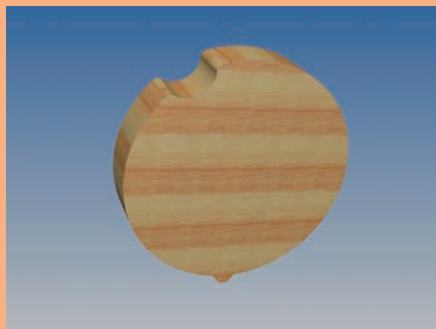
Darstellung eines Prüfkörpers für Rundholzmessanlagen mit dem Prinzip der Vollkonturmessung
